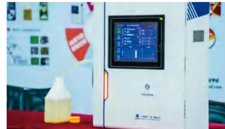
国机集团国机智能自主研发的“油液在线监测系统”拓展了重大装备状态监测手段，实现设备润滑故障远程监测及智能预警功能，打破了油液检测国外传感器垄断技术，有效预防装备的重大润滑磨损故障，提高企业的可靠性，助力企业装备智能化生产，为企业节能降耗、绿色低碳作出贡献。
