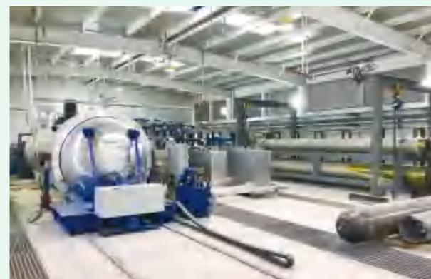
国机集团合肥通用院针对氢能储运装备开展自主研发，已在气态、固态储氢等氢能装备及关键基础零部件设计制造、测试评价与在役安全保障技术研发方面取得积极进展，研制出“氢能储运装备超高压氢循环疲劳测试系统”，攻克了超高压储氢容器、超高压氢压机、高压差高频切断球阀设计制造关键技术，解决了国产装备（储氢瓶、瓶口阀、密封件、端塞等）氢循环疲劳性能测试和进口装备安全监察难题。
